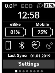
Na stavové obrazovce se vedle stavové lišty zobrazuje aktuální čas, stav nabití všech akumulátorů systému eBike a stav nabití akumulátoru chytrého telefonu, když je chytrý telefon spojený přes *Bluetooth*<sup>®</sup>.
